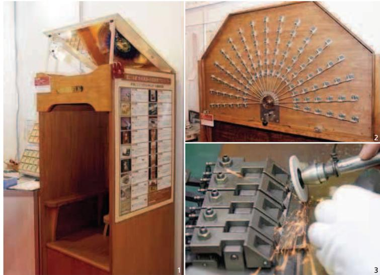
1.中に座って聴く「オルゴール音感BOX」は評価が高かった試作品の一つで、音の振動が座面を通じて体に伝わる 2.一般的な18弁オルゴールを102台連ねた「102連オルゴール」。ベートベン「交響曲第九番」を奏でる 3.諏訪に集約しているオルゴール製造は、緻密な技術が必要
