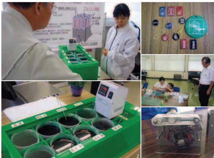
1.2.「アルミ製ネームプレート等製作」体験キットを使い、アルミニウムのネームプレートに染色とアルマイト処理を施す
