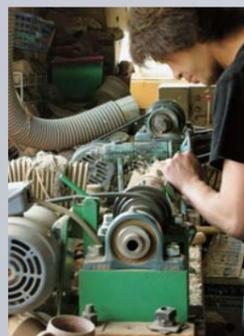
木を薄く削り出す、高橋工芸の高橋氏。しっかりと強度を保ちながらも、たわむほど薄く仕上げるには高い技術を要する。そこから磨きをかけ、手に馴染む美しい仕上げを施す
